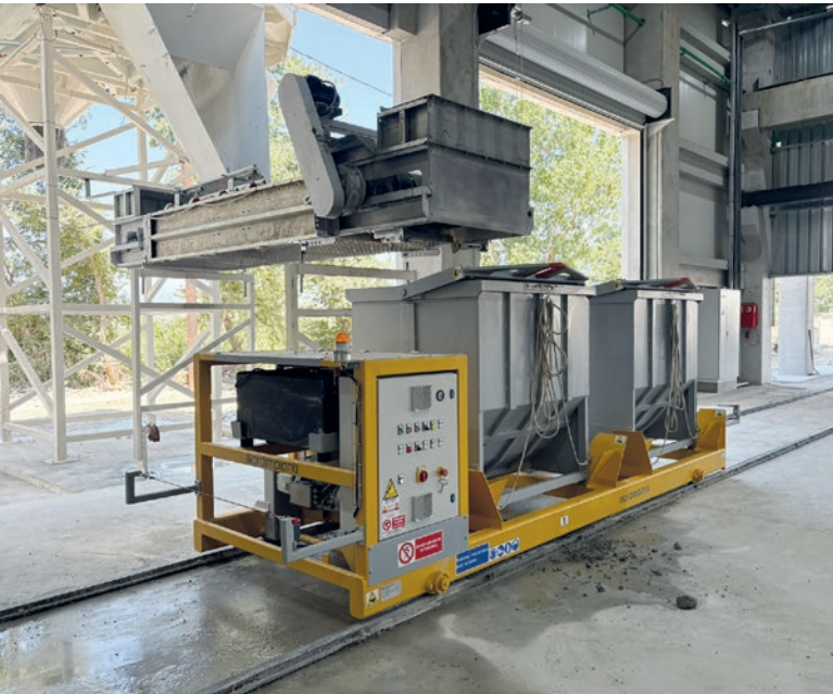
Carro de transporte accionado por batería para la cubeta de hormigón
